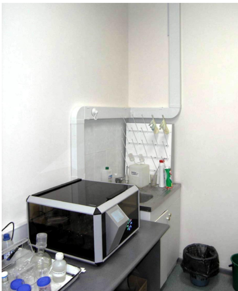
Рис. 1. Внешний вид подключенного автомата окраски мазков АФОМК8-Г/В-01 (видны воздуховод и лабораторная мойка)
